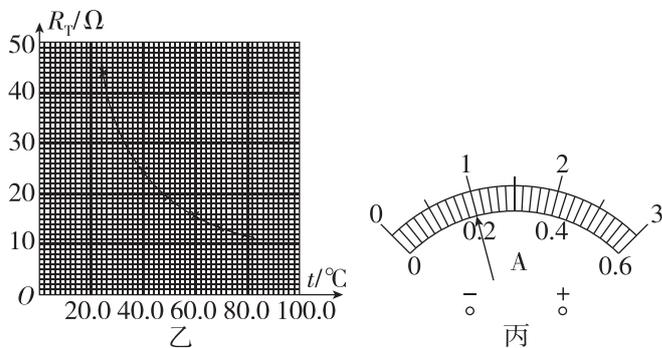
④某温度下,电压表示数为  $4.5 \text{ V}$ ,电流表示数如图丙所示,读数为 \_\_\_\_\_ A,此时热敏电阻阻值  $R_T$  为 \_\_\_\_\_  $\Omega$ .
